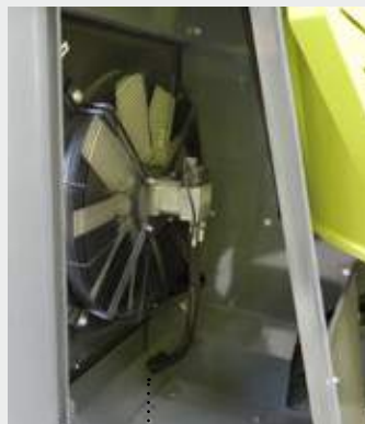
Reversiereinrichtung für Lüfterantrieb Omkeerbare koelventilator
