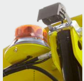
Rückfahrkamera und Rundumkennleuchte Videocamera en zwaailicht
