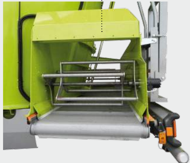
Magnet : Rotiermagnet Vaste magneet : Roterende magneet
